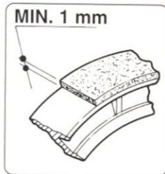
Fig. 25 (ceppo freno-spessore minimo)
