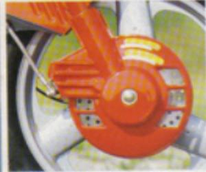
■ MOLTO BELLE LE RUOTE A TRE RAZZE IN LEGA COLOR ALLUMINIO. L'IMPIANTO FRENNANTE È DI TIPO MISTO, CON UN DISCO DA 220 MM. DIANTERAMENTE ED UN TAMBURINO DIETRO ■
