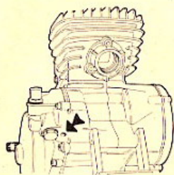
FIG. 3 Foro drenaggio liquido Liquid drainage hole
