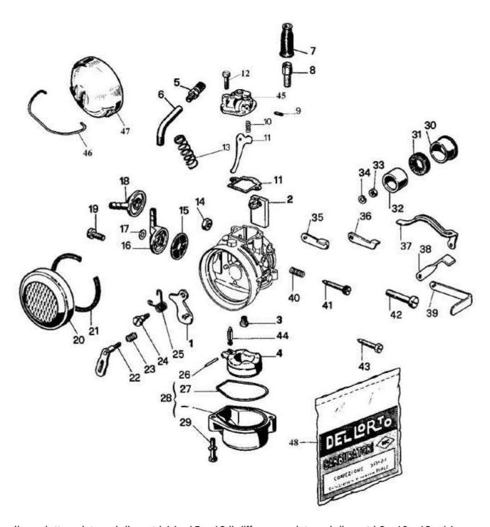
Il condotto esiste nei diametri 14 - 15 e 16 il diffusore esiste nei diametri 9 - 10 - 12 - 14 - 15 e 16. La sigla SHA del carburatore è seguita da 2 numeri che identificano i diametri del condotto e del diffusore, per esempio un SHA 14/12 significa che ha un condotto da 14 e un diffusore da 12.
