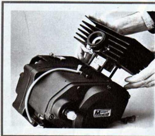
(3) Sfilare quindi, il cilindro procedendo con la massima cautela. In fase di rimontaggio lubrificare con olio motore le pareti del cilindro ed inserire il pistone all'interno della canna facendo bene attenzione a non danneggiare il segmento.
