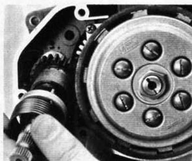
(15) La rimozione del dispositivo di avviamento si effettua con facilità a mano.
