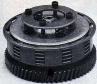
La frizione (sopra) del P 6 C.C. è molto robusta. Il carter delle molle è tenuto sempre pari dall'anello e dalle quattro viti a «brugola». La testa (sotto) ha una camera di scoppio emisferica con ammortamento squish e candela centrale. Varie le guarnizioni a sc...
