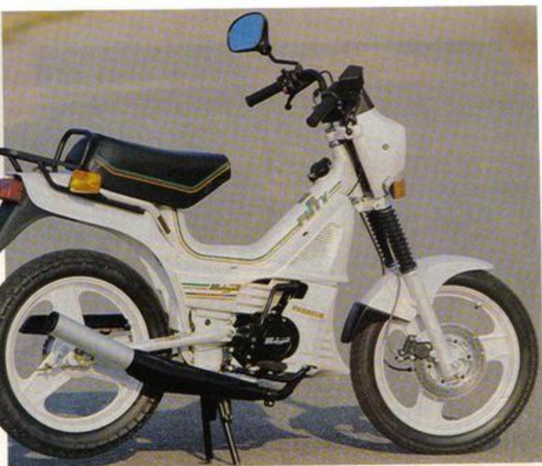
MOLTO BELLO ED ELEGANTE NELLA SUA COLORAZIONE BIANCO PERLA, IL PREMIUM È UN «TUBONE» CON SOSPENSIONE MONOAMMORTIZZATORE EQUIPAGGIATO CON MOTORE FRANCO MORINI RAFFREDDATO A LIQUIDO. IL PROPULSORE, AL PARI DEL RADIATORE, È COMPLETAMENTE AVVOLTO DA UNA SEMICARENA PERFETTAMENTE IN LINEA CON IL SERBATOIO
