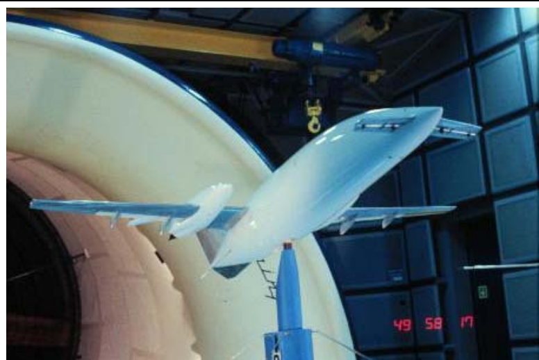
Fig. 1 Modello di velivolo in galleria del vento. Per le applicazioni aeronautiche il ricorso a modelli in scala è indispensabile al fine di abbattere i costi di sperimentazione del prototipo a dimensione naturale.
