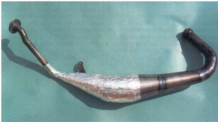
Fig. 4 – Scarico ad espansione relativo alla elaborazione del motore di Cagiva Mito 125 pubblicata nel numero 12 del 1995 di Mototecnica.
